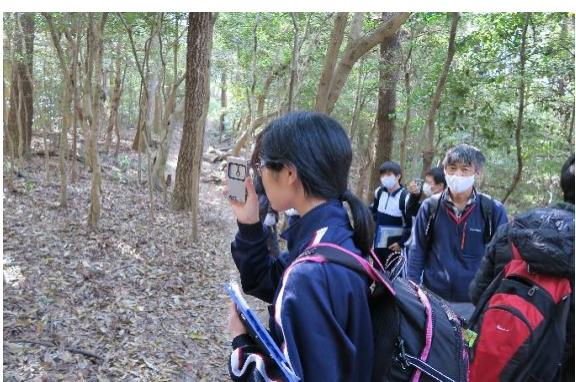
クリノメーターで傾斜の測定
