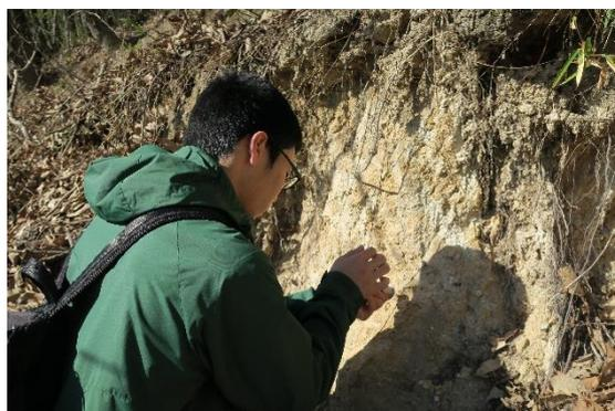
露頭で硬度測定(同一露頭で3か所測定)
