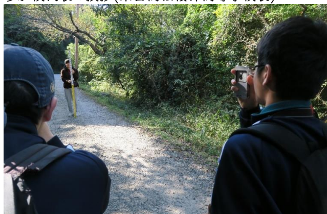
クリノメータで斜面の傾斜を測定
