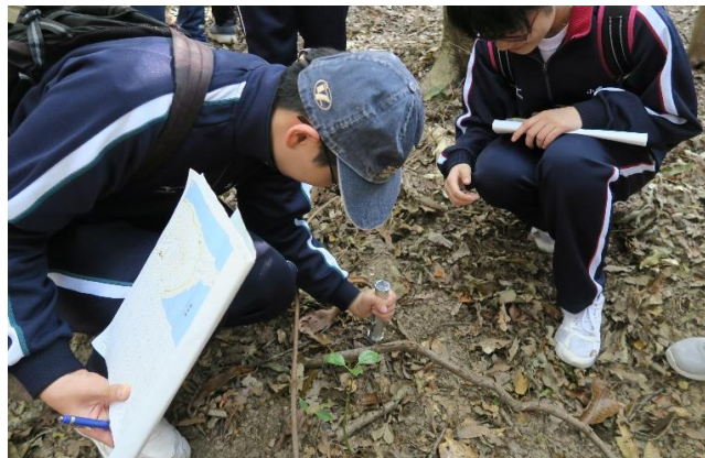
山中式土壤硬度計の操作
