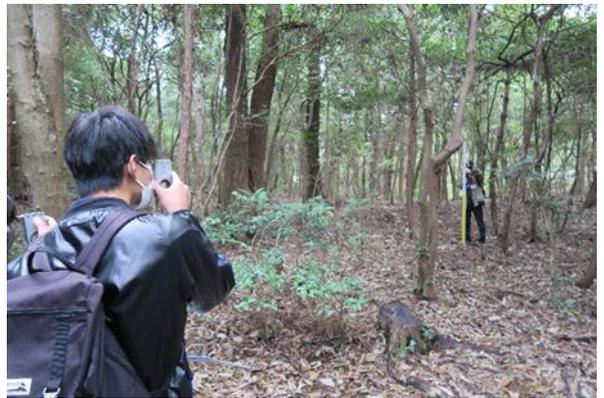
クリノメーターで傾斜の測定
